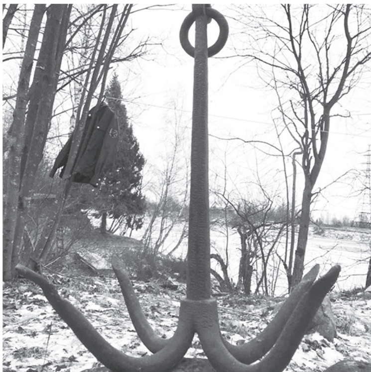
Шлюпочный (или абордажный) якорь-дрег весом 1,5 пуда. Найденный в р. Неве. На якоре надпись: «№ 14, сделано при нижнотуринском заводе: управитель Иван Черкасов, смотритель Никита Доронин, уставщик Василий Крапивин, старший мастер Федор Нефедов...»
